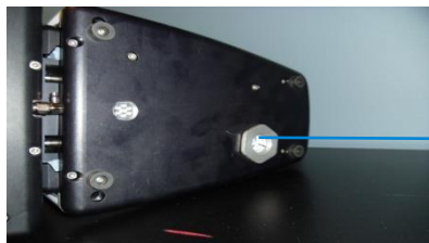
Figura 21. Localização do cartucho dessecante na parte inferior do espectrômetro FTIR Cary 630 Agilent.
