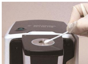
Figura 8. Limpeza da janela de amostragem do ATR de ZnSe de 5 reflexões.
