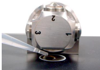
Figura 16. Posicionamento da amostra na janela de montagem da amostra do acessório DialPath.
