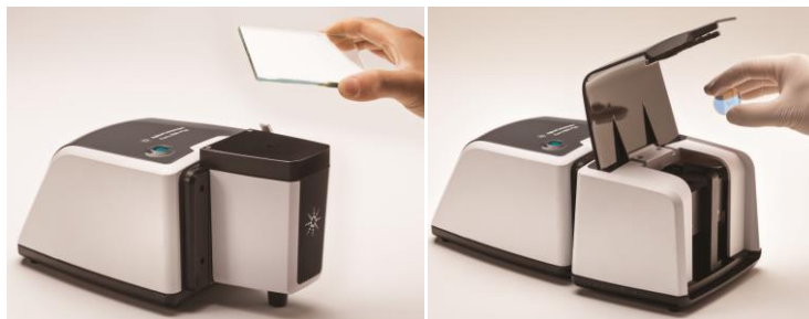
Figura 12. Introdução da amostra no acessório de SRA de 10 graus e de 45 graus.
