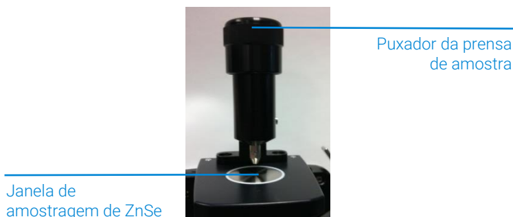
Figura 6. Prensa de amostra do acessório de ATR de ZnSe na posição mais alta.
