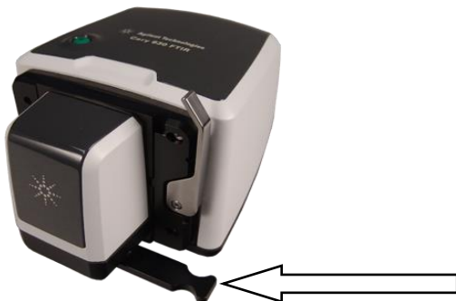
Figura 18. Acessório de Refletância Difusa fixado no FTIR Cary 630. O suporte de amostra é empurrado na entrada na parte direita inferior do acessório.
