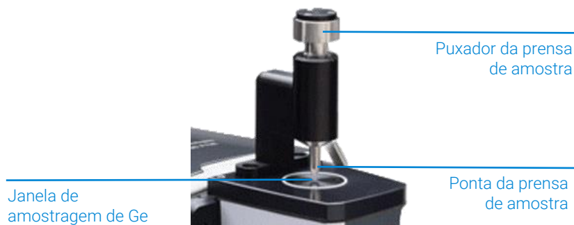
Figura 7. Prensa de amostra do acessório de ATR de Ge.
