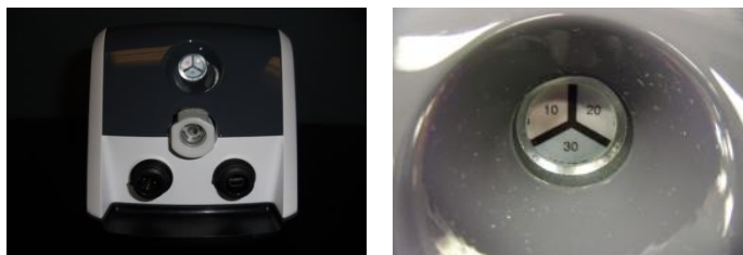
Figura 20. Indicador de umidade na parte de trás do espectrômetro FTIR Cary 630 Agilent (à esquerda) e uma imagem aproximada do indicador (à direita).
